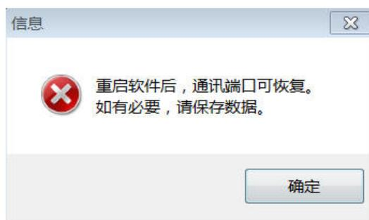
通信时通信电缆切断再次接通而不重新启动程序，继续进行通信时的错误弹窗
