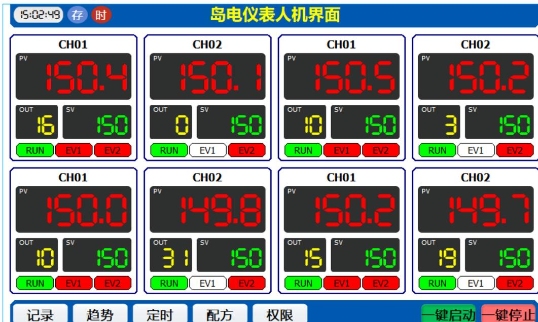
[ 群组 ] 窗口显示有每个回路的测量值 pv、设定值 sv、输出百分比 out，及运行和 EV 报警灯状态。人机界面上电完成后，首先进入群组窗口，如果连接的是单台仪表，则会跳过 [ 群组 ] 窗口直接进入 [ 单控 ] 窗口。
