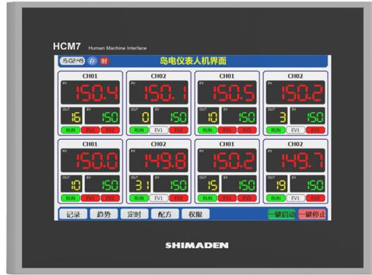
HCM 系列人机界面专用于配合岛电仪表产品，可以同时与单台或多台岛电仪表通讯，可在触摸屏上直接操作仪表启停，设置温度、曲线、PID、EV 报警等通讯支持的参数，使仪表操作更加容易。另外扩展了历史记录，操作记录，数据导出，定时启停，权限管理等功能，提高了在仪表使用中的方便程度。还可以根据用户要求，实现双屏同时控制、转发给第三方设备等功能。
